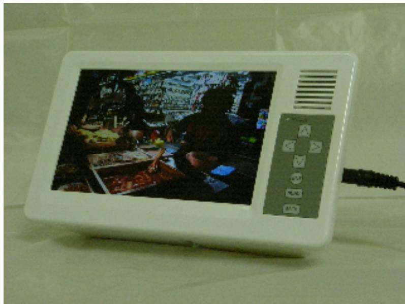
JR 高速船ビートル船内で貸し出す7インチ型のパーソナルサイネージ(フォトフレーム)。博多停泊中にマルチメディア放送の電波を使って、コンテンツを最新のものに更新するもの。コンテンツは IPDC 方式で送信される。
