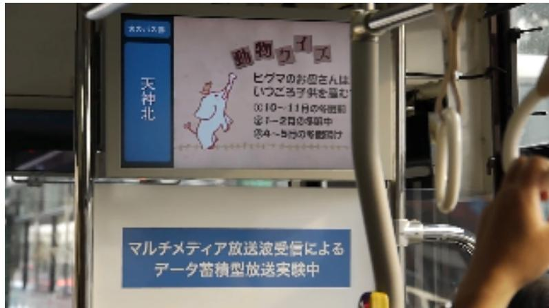
路線バス車内前方に設置したデジタルサイネージ端末のコンテンツを、放送波で最新のものに更新。コンテンツは IPDC 方式で送信し、バスの走行中にデータを受信し更新するもの。
