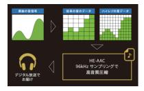
CD を超える高解像度の音声データ(ハイレゾ音楽)はリアルな再現性が特徴ですが、データ量が多いため、従来の放送フォーマットでは放送することができませんでした。新放送サービス i-dio は、高音域を低音域から生成する SBR 技術を採用することで、96kHz サンプリング HE-AACフォーマットでハイレゾに迫る地上波最高音質の放送「i-dio HQ」を可能としました。
